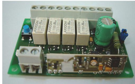
La scheda di decodifica HCS-DEC-1-2-4/F è una centralina a 1-2-4 canali comandata da un qualsiasi trasmettitore con encoder HCS Keeloq Trademark di Microchip, programmato con codice Aur°el. Dispone della doppia alimentazione (12Vdc oppure 24Vac) selezionabile prima di alimentarla tramite un jumper. I quattro relè montati a bordo possono funzionare indistintamente in modo monostabile o bistabile a seconda delle esigenze.
